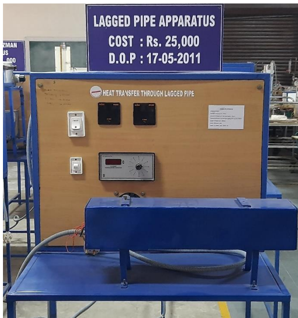
Fig. 7 Lagged pipe apparatus
